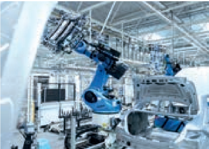
Kennzeichen der Factory 56: IoT-fähige Robotik, fahrerlose Transportsysteme, 5G sowie die Integration ins digitale Ökosystem „MO360“.
