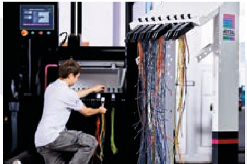
Oliver Curty (links) und Oliver Hirsiger (oben) bedienen bei der Elpex AG das Rittal Wire Terminal WT36 , mit dem sich ohne Umrüstung bis zu 36 unterschiedliche Drähte in den Querschnitten von 0,5 mm 2 bis 6 mm 2 vollautomatisiert ablängen, abisolieren, crimpen, beschriften und auftragsbezogen sortieren lassen.
