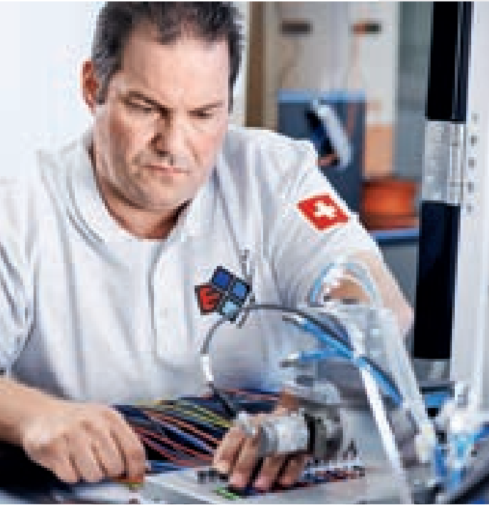
Oliver Curty (links) und Oliver Hirsiger (oben) bedienen bei der Elpex AG das Rittal Wire Terminal WT36 , mit dem sich ohne Umrüstung bis zu 36 unterschiedliche Drähte in den Querschnitten von 0,5 mm 2 bis 6 mm 2 vollautomatisiert ablängen, abisolieren, crimpen, beschriften und auftragsbezogen sortieren lassen.
