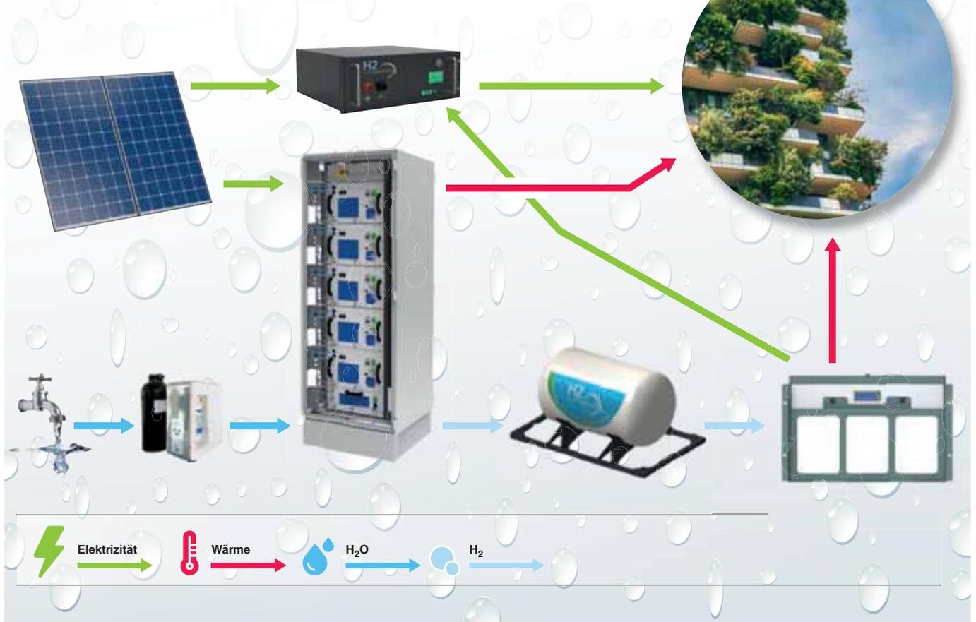
ert die wichtigen AEM-Elektrolyseure bei: „Enapter baut besonders kleine Module, die sogenannten Stacks. Neben der Größe ist vor allem deren Verfügbarkeit ein Vorteil – fällt ein Stack in einer Anlage aus, laufen die anderen weiter. Es gibt keine Verluste, und man kann die Stacks relativ einfach austauschen“, erklärt Küter.
