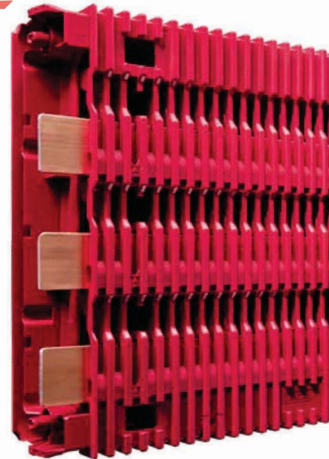
Da bei RiLineX die Kupferschienen ohne spezielle Sammelschienenhalter direkt im Board verbaut sind, lassen sich die Aufbau-Komponenten einfach durchgängig planen und montieren. Zertifiziert ist der Berührungsschutz nach der Schutzart IP2XB.
