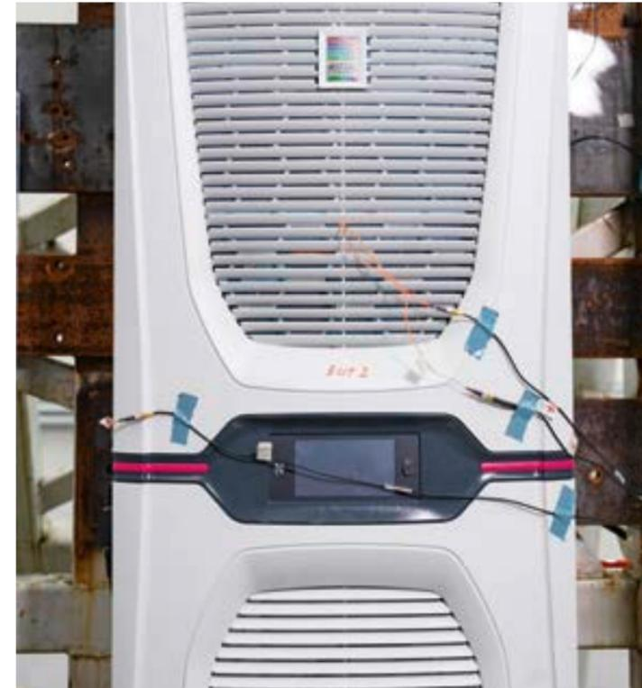
Auf „Herz und Nieren“ geprüft: Unter Laborbedingungen werden Vibrationen nachgestellt, wie sie durch einen Schiffsdieselmotor auf einem Schiff erzeugt werden, und deren Auswirkungen auf Kühlgeräte gemessen.
