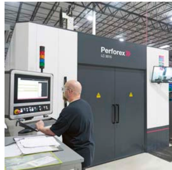
Das Lasercenter Perforex LC ist ideal für die automatisierte mechanische Modifizierung von Schaltschränken aus Edelstahl und Stahlblech.
