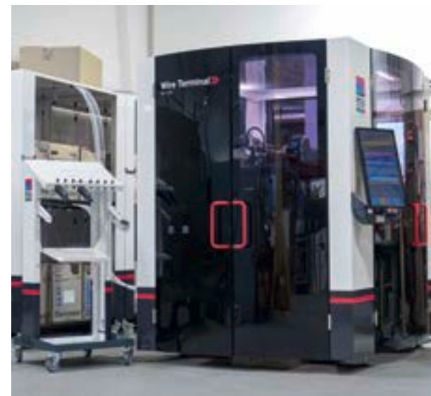
Usemco setzt bei der vollautomatischen Drahtkonfektionierung auf das Wire Terminal WT C von Rittal.
