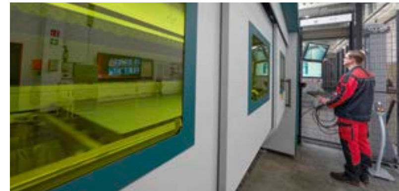
Die neue Laserschneidanlage schneidet aus Feinblech jede beliebige Form und Stückzahl.
