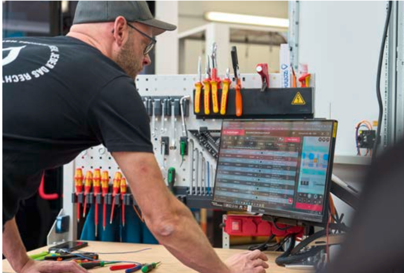
Ein Blick auf Eplan Smart Mounting genügt, und der Werker hat alle Informationen zur Bestückung von Komponenten im Schrank.
