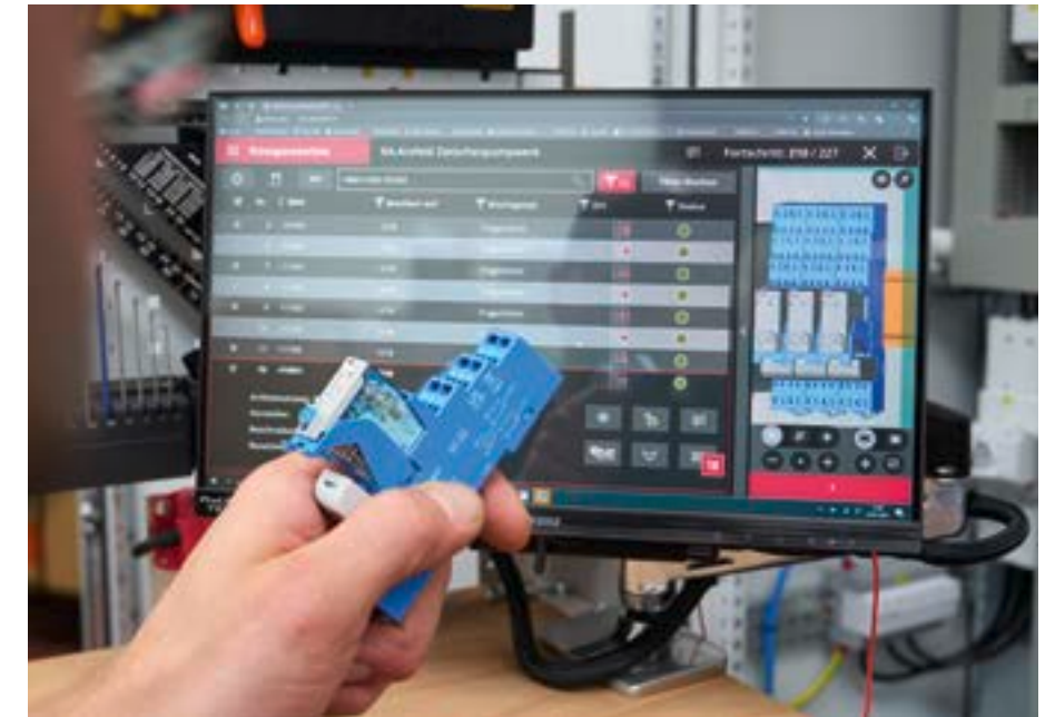
In Eplan Pro Panel entsteht der digitale Zwilling der Schaltschränke, welcher als Basis für die Fertigung mit Smart Mounting dient.
